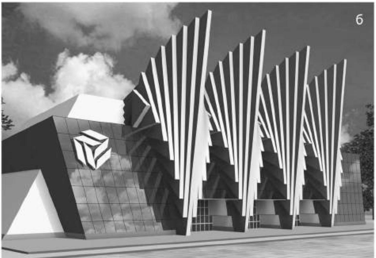
Рисунок 114 - Фасады имиджевых индивидуальных жилых домов. Дизайн решений определяется ритмически расположенными многогранными остроугольными объемами с введенными элементами национальной стилистики (а), а также симметрично расположенными конусообразными оболочками, содержащими ленты наклонных витражей и остекленные вертикальные торцы (б). Автор концептов и рисунков Коротич А.В.
