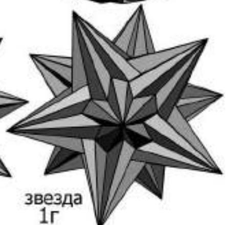
Рисунок 76 - Новые типы изоэдральных сферических разбиений, а также производных звездчатых и сотовых многогранников, созданных преобразованием исходных сферических проекций простейших базовых равнозлементных многогранников. Разбиения паркетируются выпуклыми, невыпуклыми и звездчатыми сферическими отсеками, очерченными плоскими/неплоскими кривыми. Автор алгоритмов, новых разработанных моделей и рисунков Коротич А.В.
